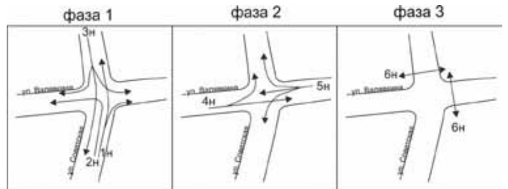
Рисунок 36 – Схема пофазного разъезда для варианта проектирования 4.
