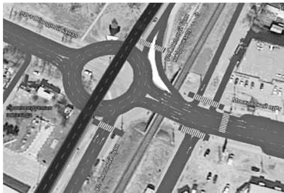
Рисунок 59 – Предлагаемая транспортная схема.
