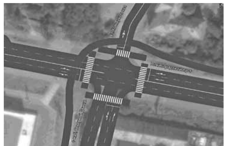
Рисунок 51 – Транспортная схема для варианта проектирования 3.
