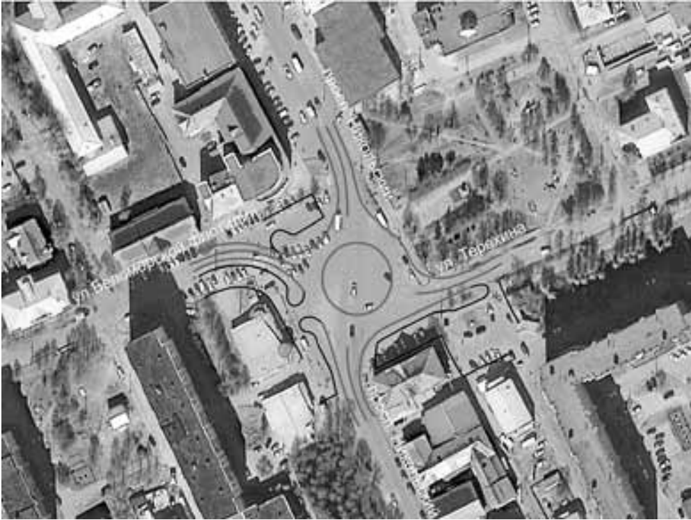
Рисунок 20 – Схема варианта 2 на пересечении ул. Терехина и проспекта Никольского (пл. Терехина) с кольцевым саморегулируемым пересечением.
